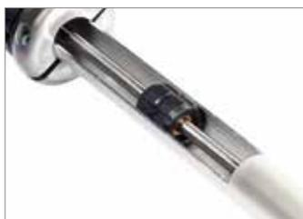
Asta trasmissione rigida, Ø 8 mm: elevata affidabilità grazie all'albero di trasmissione rigido che scorre su 6 bronzine auto-lubrificanti.
