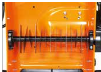
Rotore composto da 15 coltelli fissi.
