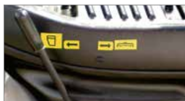
Sistema "Change over", che, tramite una comoda leva, consente di chiudere il tunnel di carico, passando automaticamente dalla funzione di raccolta alla funzione mulching.
