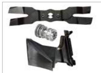
Kit per mulching opzionale: l'erba viene tagliata in particelle finissime che si depositano alla base del manto erboso per dare al prato un taglio pulito e sempre uniforme (lama + mozzo porta lama + tappo).
